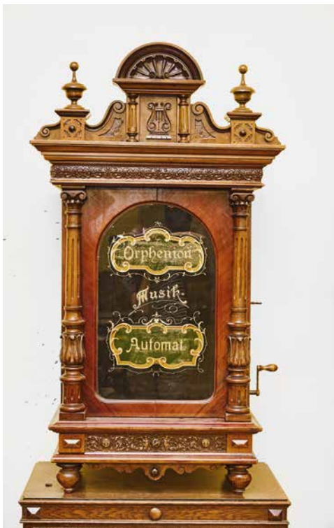
Leipzig war um 1900 ein Zentrum mechanischer Musikinstrumente; wie der „Plattenspieler“ der Firma Polyphon oder die Musikautomaten der Firma Orphenon. Letztere wurden für Gaststätten gefertigt. Wie beim Wurlitzer wurde eine Münze eingeworfen, die Lochkarten-Platten brachten die Hits der Zeit zu Gehör.
