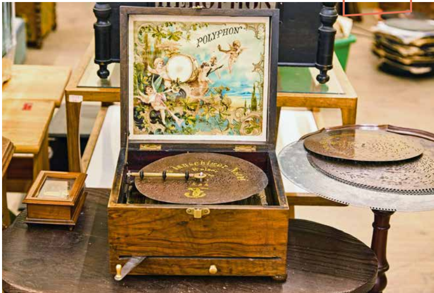
Auf Lochstreifen oder Lochplatten wurde die Melodie gespeichert und durch einen Mechanismus wieder abgetastet – wie bei diesem „Plattenspieler“ der Marke Polyphon aus Leipzig.
